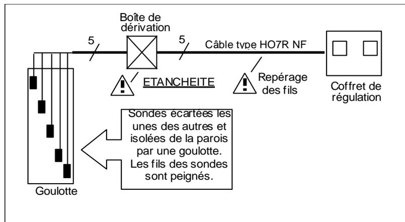
Pour garantir un bon fonctionnement de l'installation il est indispensable d'assurer l'étanchéité de la boîte de dérivation et un bon isolement galvanique des contacts. L'utilisation de colle silicone est recommandée.
