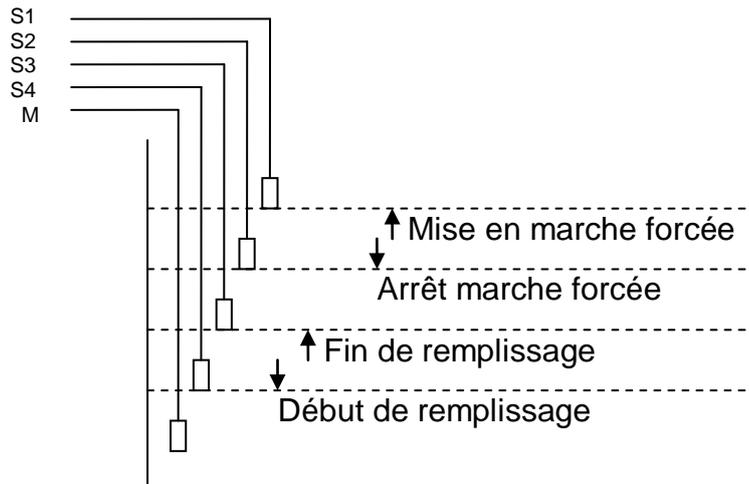
NIVA5 utilise 5 sondes de niveau. Les sondes doivent être positionnées dans le bac tampon de manière à ce que le niveau de mise en marche forcée (S1) se trouve en dessous de la sur verse du bac tampon.
