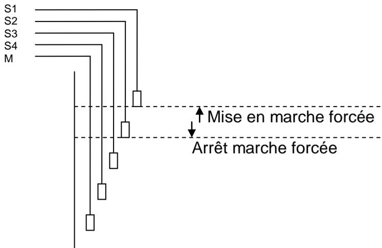
Le trop plein est détecté lorsque le niveau d'eau est supérieur à la sonde S1. La pompe de filtration est alors mise en marche forcée jusqu'à ce que le niveau redescende en dessous de la sonde S2.
