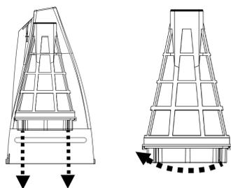
4. Rincer le compartiment transparent et nettoyer les débris à l'intérieur du cône filtrant. Il est recommandé de nettoyer le filet du cône filtrant avec une projection d'eau. Si un brossage est considéré nécessaire, utiliser uniquement une brosse douce pour le nettoyer avec soin et précaution. N'APPLIQUER aucune pression au filet.
