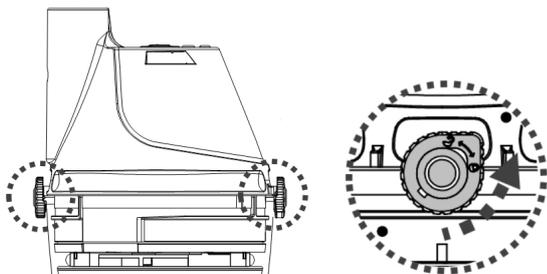
3. Faire basculer le compartiment transparent et s'assurer que la plus petite extrémité est orientée vers le haut, ensuite pousser le cône filtrant hors du compartiment transparent. Tenir le cône filtrant horizontalement et tourner son couvercle dans le sens horaire pour le séparer du cône.
