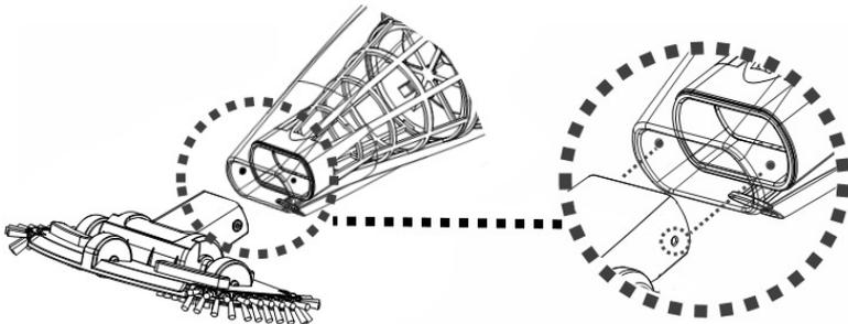
NOTE : Pour remplacer les brosses sur la tête d'aspiration, soulever l'extrémité et la pousser dehors pour laisser un espace pour une nouvelle.
