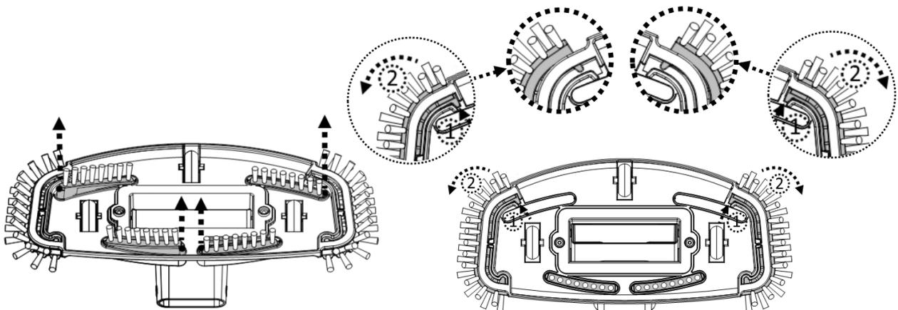
**AVERTISSEMENT !** Pour les piscines/spa en fibre de verre et celles avec une doublure en vinyle, il est recommandé de laisser les brosses sur la tête d'aspiration afin d'éviter d'endommager la piscine/spa..
