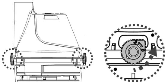
2. Placer le corps arrière (renversé - bouton marche/arrêt face en dessus) sur une surface plate. Aligner et faire glisser le crochet de la base de chargement sur l'encoche latérale au fond du corps arrière jusqu'à ce qu'il s'arrête. S'assurer que leurs plots entrent en contact correctement. Brancher la prise femelle de l'adaptateur externe dans le port de chargement à la fin de la base de chargement.
