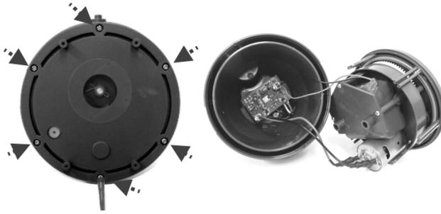
4. Pour séparer le fil de connexion de la batterie, appuyer sur le clip du connecteur et le pousser vers l'extérieur. NOTE : Enrouler immédiatement un ruban isolant sur le connecteur afin d'éviter un court-circuit causé par le contact des deux cosses de câble.
