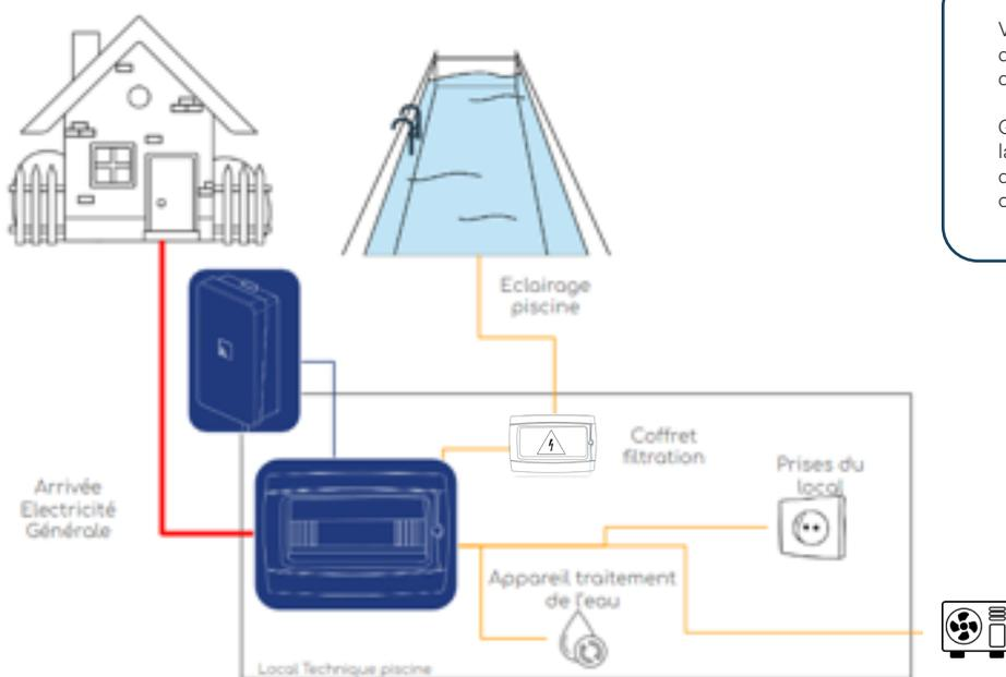
VigW@tt permet un monitoring complet de l'énergie consommée par l'installation de la piscine.
